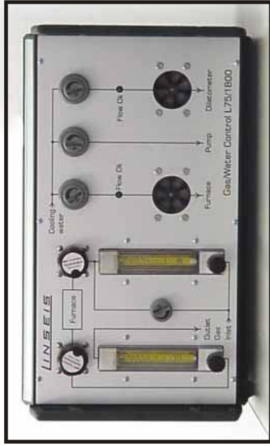
2 Gasdurchflussmesser 3 fache Kühlwasserkontrolle für Ofen, Dilatometer und Pumpe
