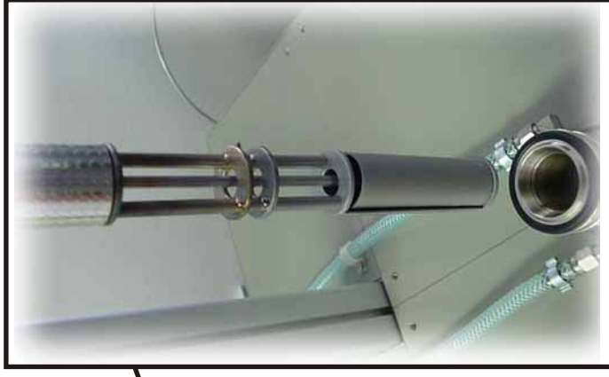
Tantalmesssystem für Temperaturen bis 1800°C
